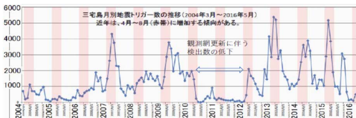
図 11. 三宅島に設置された地震観測網での月毎のトリガー回数。一般的にトリガー回数は地震の発生回数と相関がある。2006 年後半からトリガー数が増加していることから、この頃より浅部での地震活動が活発になったと想像される。
