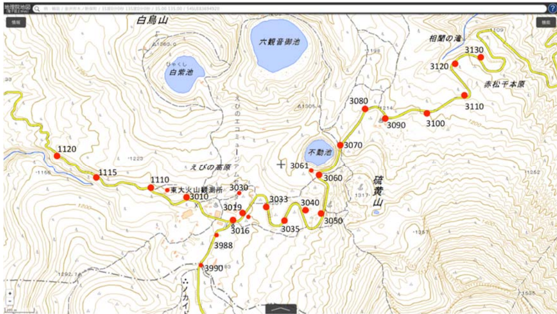
図 2. 霧島山えびの高原（硫黄山）周辺における水準測量路線。赤丸の点が測点。
